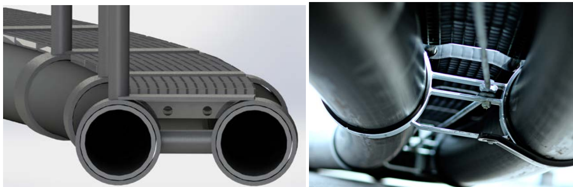
Figur 18: Typisk flytekrage med plastklammer (venstre, illustrasjon: SINTEF) og ståklammer (høyre, foto: Aqualine)
